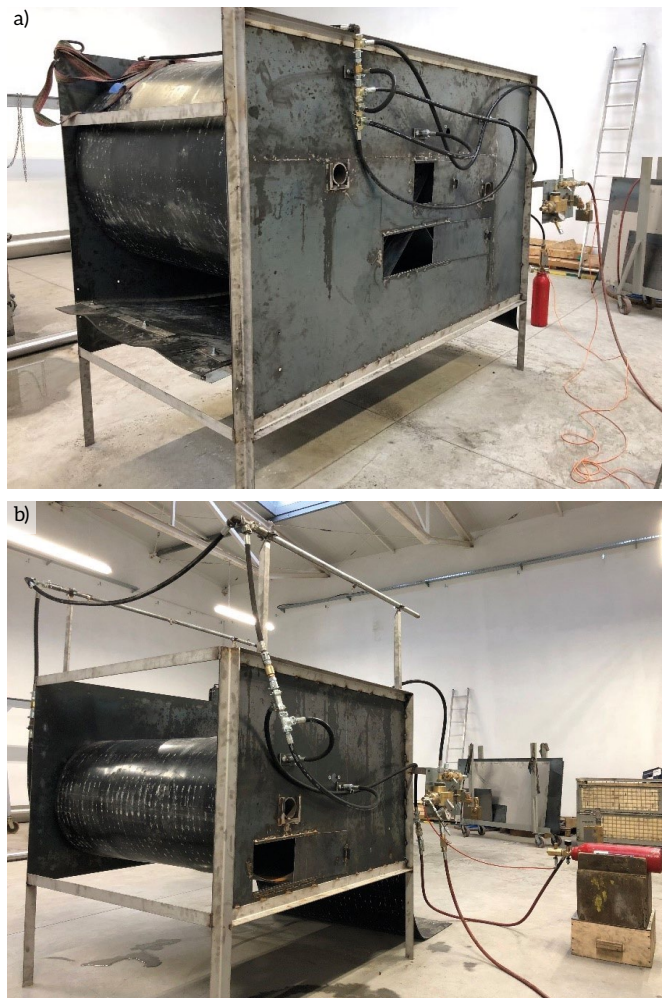
Rys. 4. Stanowisko badawcze z zabudowanym systemem gaszenia mgłowego: a) napędu; b) zwrotni/wysięgnika [2]
