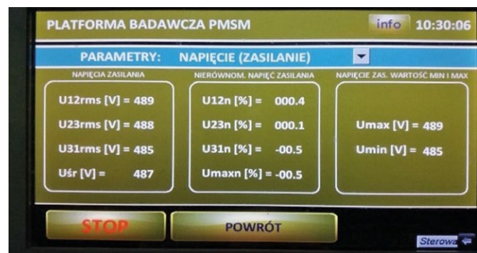
Fot. 15. Parametry napięć zasilania platformy badawczej
