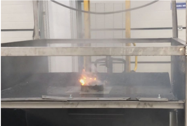
Rys. 11. Próba gaszenia materiału palnego w miejscu taśmy górnej przenośnika przy użyciu wody (moment rozpoczęcia gaszenia płomienia) [2]
