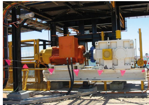
Fot. 5. Napęd heavy duty Rossi w zastosowaniu przenośnikowym
