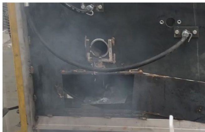
Rys. 10. Próba gaszenia materiału palnego w miejscu kołnierza bębna zwrotni/wysięgnika przenośnika taśmowego (moment gaszenia płomienia środkiem gaśniczym) [2]
