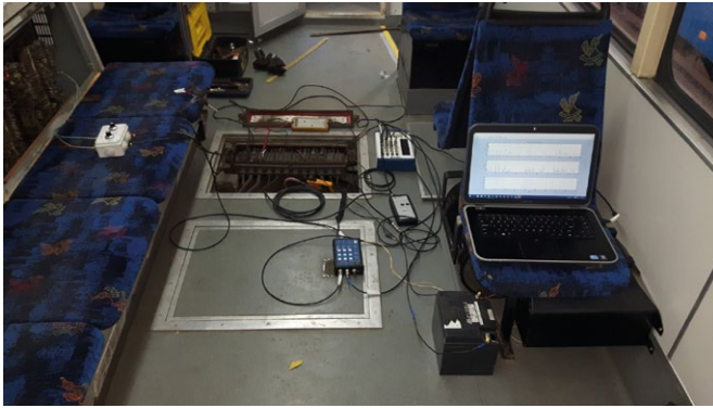
Rys. 7. Układ pomiarowy do badań układu napędowego z silnikiem prądu stałego
