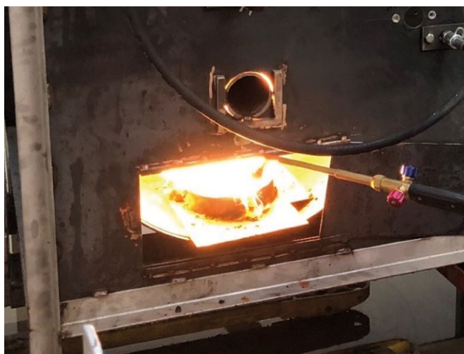
Rys. 6. Pryzma materiału palnego zapalana płomieniem palnika [2]
