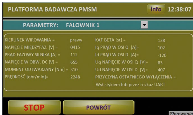
Fot. 12. Okno z podstawowymi parametrami pracy falowników zasilających silniki
