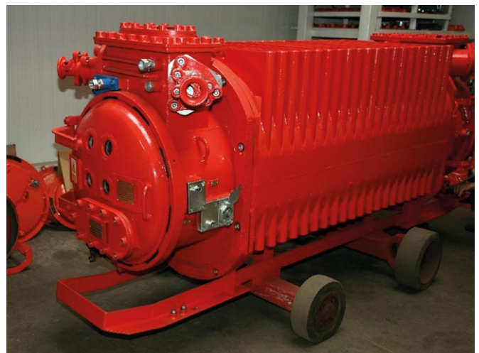
Rys. 2. Ognioszczelna stacja transformatorowa
