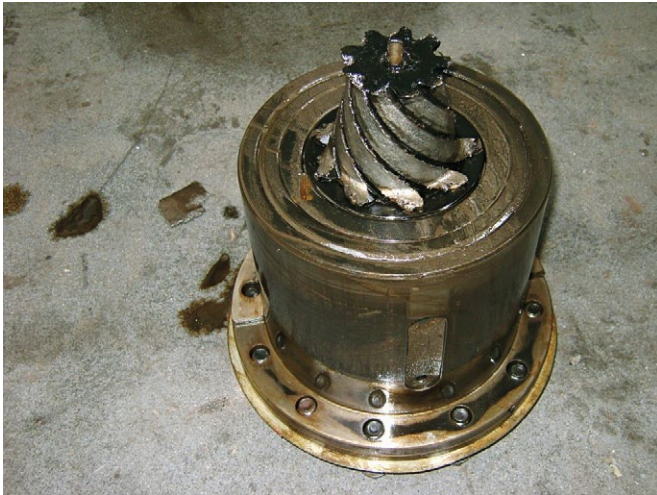
Rys. 16. Uszkodzony zębniak przekładni
