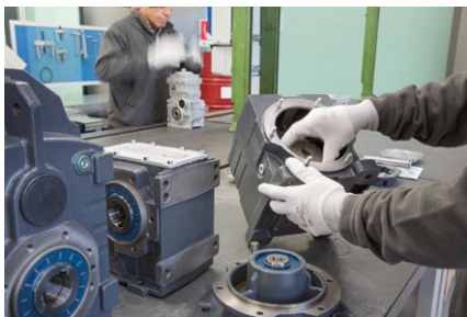
Fot. 4. Montaż przekładni IRON
