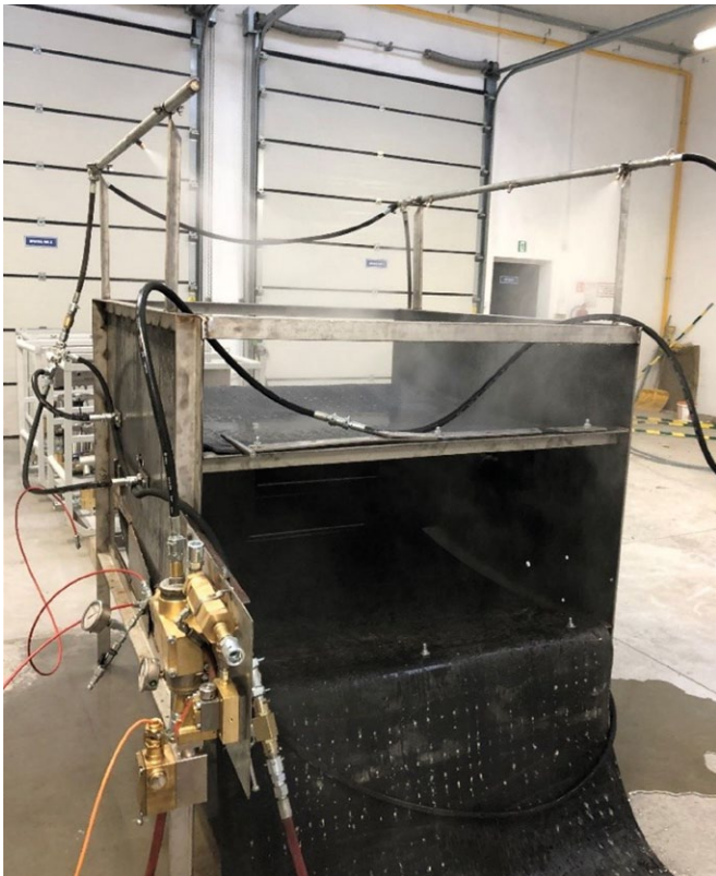
Rys. 7. Woda rozpylana przez dysze mgłowe baterii gaszącej [2]
