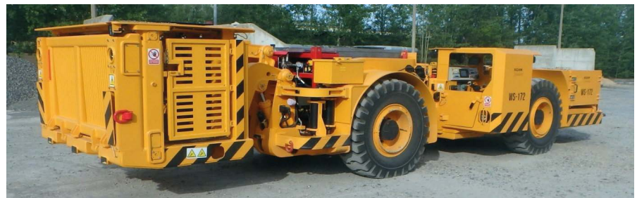
Wóz strzelniczy WS-172 (wysokość przejazdu: 1800 mm, wyposażony w podest koszowy o wysokości podnoszenia: 2200 mm)
