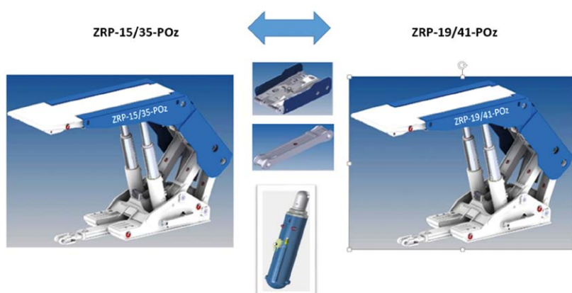
Rys. 7. Unifikacja konstrukcji sekcji zmechanizowanych obudów ścianowych
