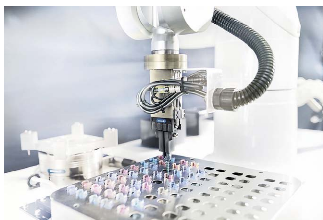
Chwytnak 24V do małych komponentów EGP firmy SCHUNK to specjalista od zastosowań montażowych
