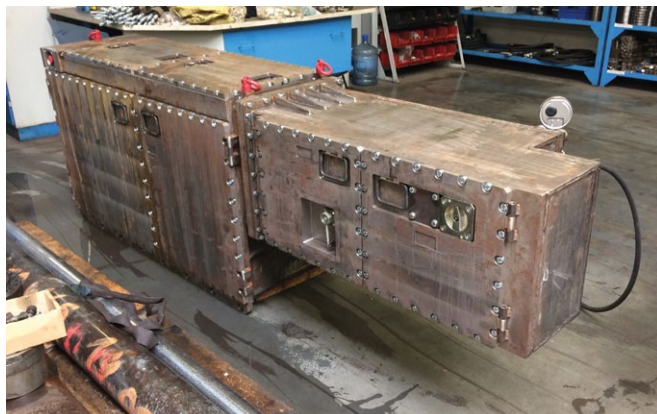
Rys. 3. Osłona przeciwwybuchowa układu zasilająco-sterującego [7]
