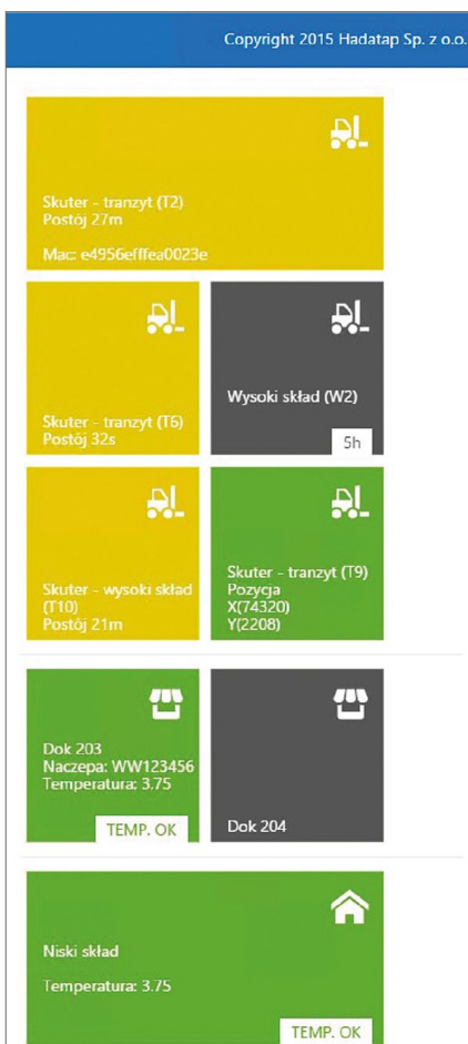
Rys. 3. UWB RTLS do monitorowania wózków widłowych - śledzenie ruchu wózka w czasie rzeczywistym (1) 20
