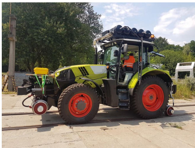
Rys. 1. Ciągnik szynowo-drogowy z podłączoną aparaturą badawczą
