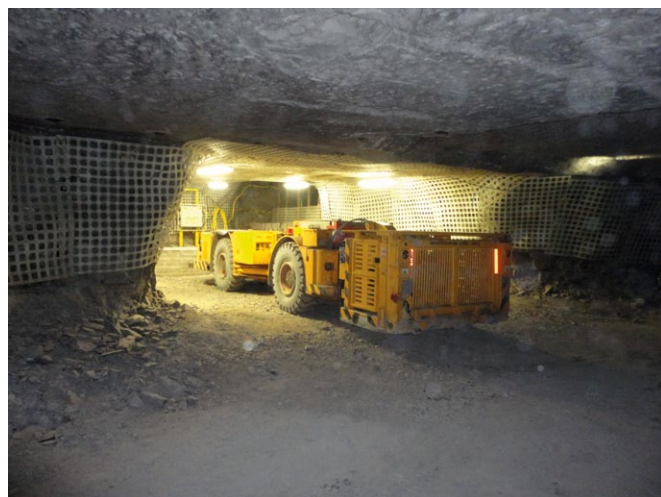
Rys. 9. Samojezdny wóz strzelniczy WS-172 podczas prób eksploatacyjnych w podziemiach kopalni rudy miedzi - ładowanie baterii[2]
