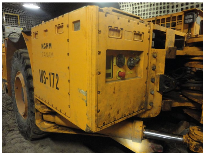
Rys. 2. Moduł baterii zabudowany na wozie strzelniczym [2]
