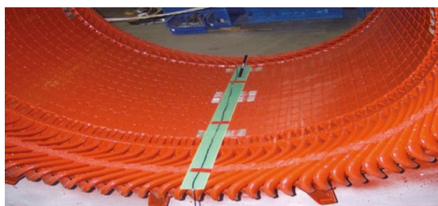
Rys. 18. Antena paskowa własnej konstrukcji przyklejona do stojana
