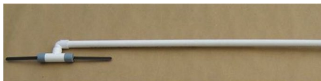
Rys. 19. Sonda do pomiarów wnz własnej konstrukcji z wykorzystaniem anteny paskowej
