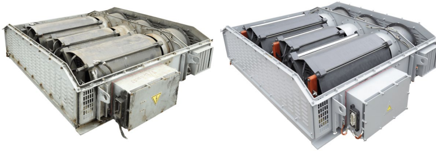
Rys. 3. Zestaw cewek w obudowie przed i po remoncie. Zestaw przeznaczony do pracy na dachu pojazdu w strefie zabrudzeniowej PD4 (tabela 2)
