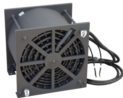
Rys. 2. Cewka AirECO™ – 1 mH/450 A z powłoką silikonową dla stref zabrudzenia PD4. Montaż w obudowie przetwornicy, w strefie brudnej
