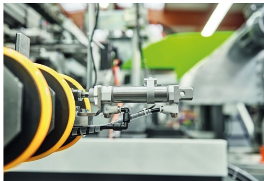
Aby monitorować zużycie amortyzatora w siłowniku pneumatycznym, brama brzegowa przeanalizuje sygnały z czujnika skoku końcowego w celu oceny skuteczności amortyzacji
