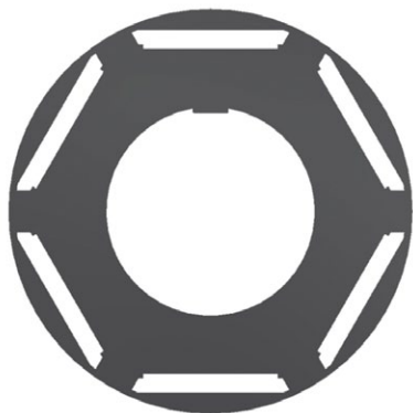
Rys. 3. Widok blachy wirnika modelowego elektrowibratora
