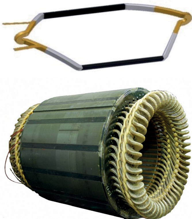
Rys. 2. Cewka i rdzeń stojana uzwojony silnika 6000 V
