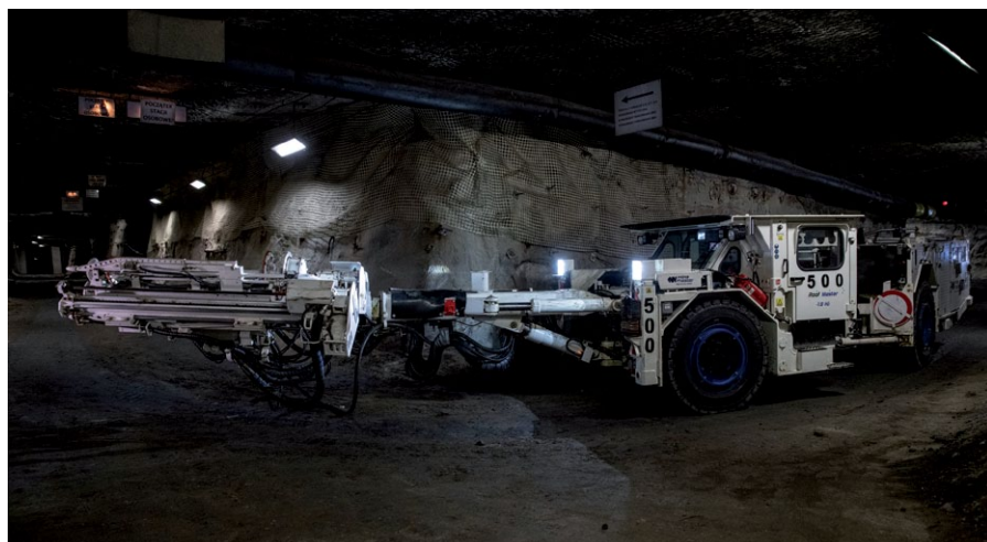
Rys. 1. Zasilany bateryjnie elektryczny samojezdny wóz kotwiący Roof Master 1,8KE firmy Mine Master w wyrobisku KGHM Polska Miedź SA [2]
