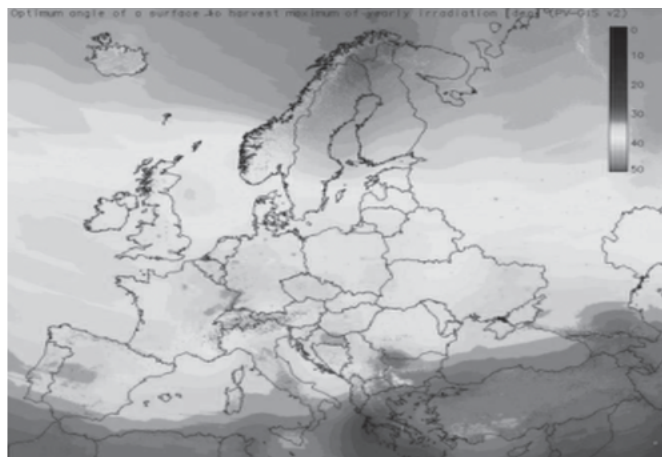
Rys 5.7. Wartości kąta optymalnego pochylenia powierzchni absorbującej promieniowanie słoneczne [15]
