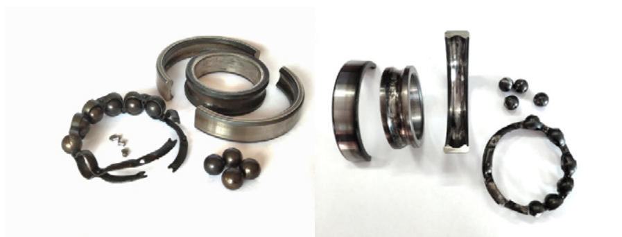
Rys. 1. Całkowicie uszkodzone łożysko - konsekwencja płynących prądów łożyskowych.
