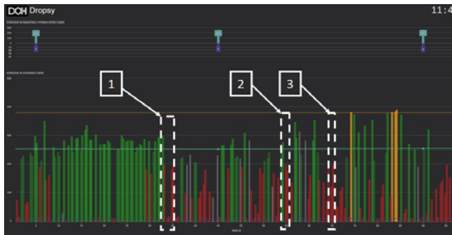
Rys.1. Wizualizacja ciśnienia w stojakach analizowanych sekcji, gdzie: 1 - ciśnienie-sekcja 33-35, 2 - ciśnienie-sekcja 60, 3 - ciśnienie-sekcja 70
