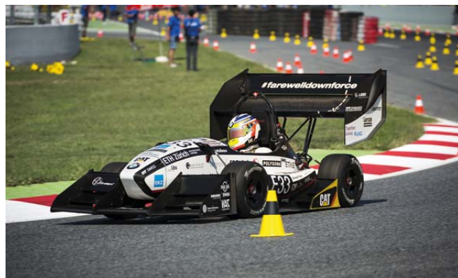
Waga lekka świata samochodów wyścigowych: dzięki zastosowaniu materiałów z włókien węglowych „grimsef” waży zaledwie 168 kilogramów
