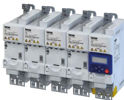
Rys. 6. Montaż książkowy przemienników Lenze serii i500 nie wymaga nawet 1 mm odstępu między urządzeniami
