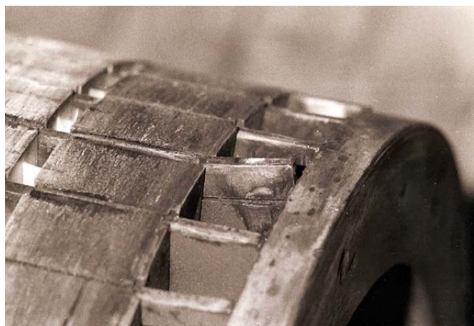
Rys. 12. Odgięty w kierunku promieniowym segment dzielonego pręta
