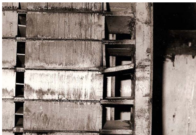
Rys. 13. Odgięte siłą bezwładności nagrzane pręty przy rewersie
