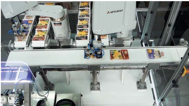
Zintegrowane stoisko miksujące opakowania wyposażone w roboty przemysłowe Mitsubishi Electric
