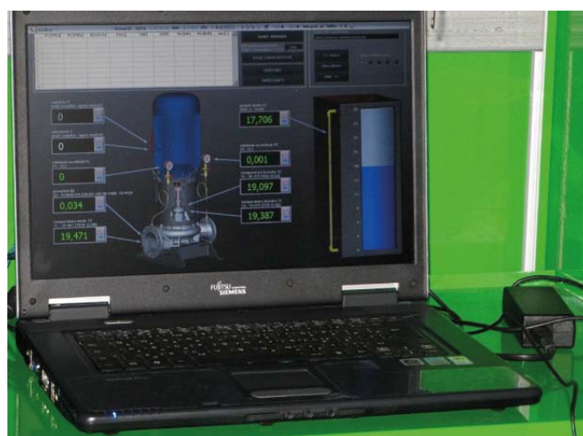
Rys. 5. Komputer pomiarowy z uruchomionym programem - ekran zbierania danych pomiarowych
