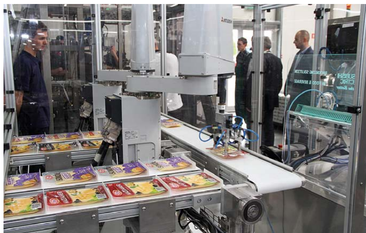
Zintegrowane stoisko miksujące opakowania wyposażone w roboty przemysłowe Mitsubishi Electric
