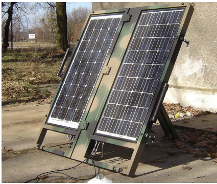
Rys. 9. Panel fotowoltaiczny przewodzący systemu zasilania
