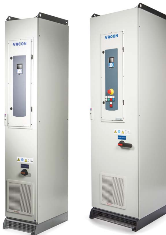
Rys. 1. Przetwornice serii VACON 100 – szafy szerokości 400 mm – do 110 kW, 600 mm do 315 kW, 1200 mm do 630 kW (dla 400 V). Widoczna osobno otwierana sekcja sterowania wraz z elementami sterowania lokalnego
