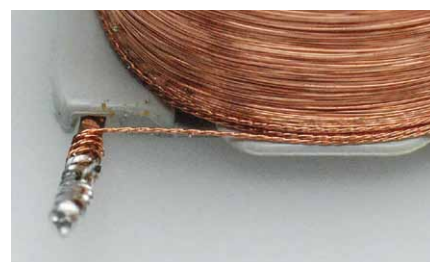
Dodatkowe lutowanie dla połączenia uzwojenia cewki
