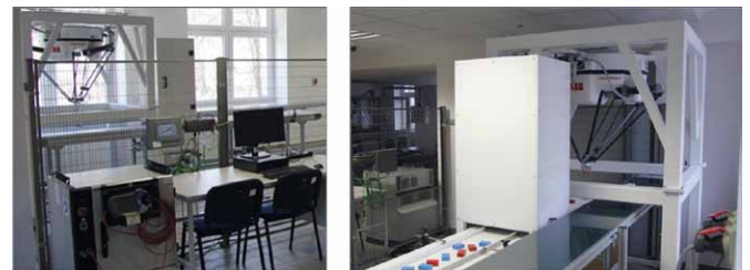
Rys. 8. Stanowisko do sortowania detali z robotem IRB 360 firmy ABB
