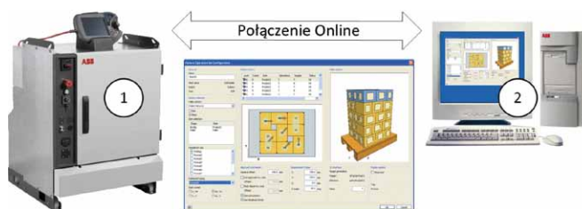
Rys. 7. Elementy systemu PickMaster5 firmy ABB: 1 – kontroler IRC5; 2 – komputer z programem PickMaster5 (źródło: ABB)
