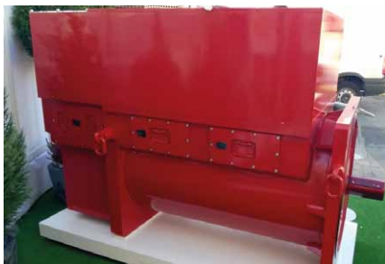
Fot. 1. Silnik typu: SG3F 4505X-4D (850 kW, 3300 V)
