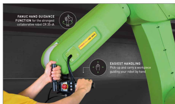
Rys. 27. Konstrukcje modułu dedykowanego do uczenia robotów kolaboracyjnych firmy FANUC (źródło: FANUC)
