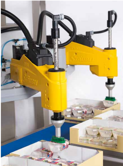
Roboty Staubli TS80 Scara są w stanie sprostać złożonym wymaganiom stawianym przez producentów urządzeń
