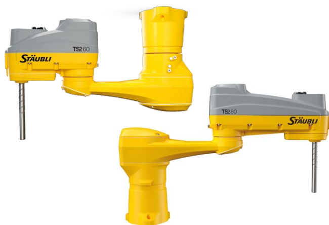
Rys. 5. Nowa rodzina robotów SCARA firmy Staubli obejmuje cztery modele: TS2-40, TS2-60, TS2-80 oraz TS2-100. Każdy charakteryzuje: zamknięta konstrukcja, całkowicie hermetyczna obudowa (której połączenia ukryte są wewnątrz konstrukcji, pod cokołem robota)
