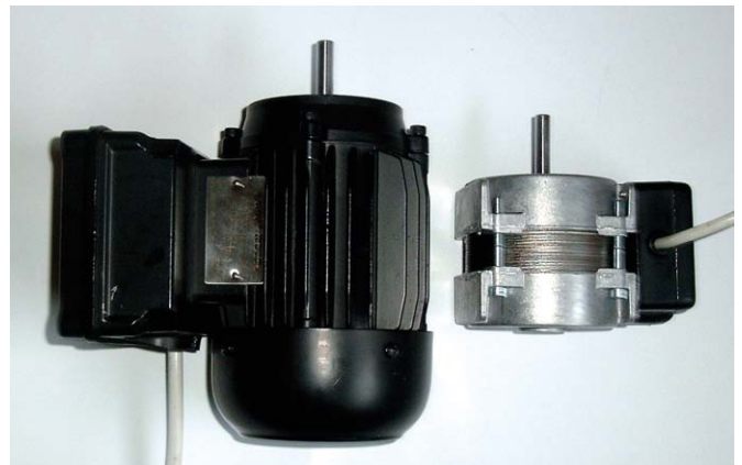
Rys. 4. Dotychczasowy i nowy silnik wentylatora
