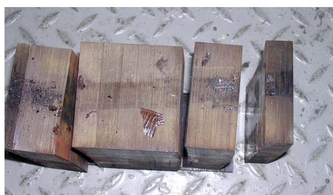
Rys. 7. Zniszczone mocowanie rdzenia i przesunięte fragmenty rdzenia
