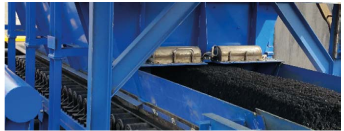
Fot. 1. Głowice pomiarowe jednego z popiołomierzy mieszalnika
