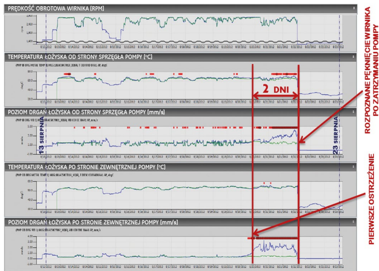
Rys. 15. Rozpoznanie anomalii ST pompy
