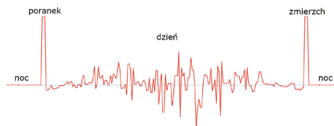
Rys. 3. Przykładowa dobowa zmienność mocy biernej generowana przez falownik pracujący w trybie utrzymywania \cos \varphi = 1
