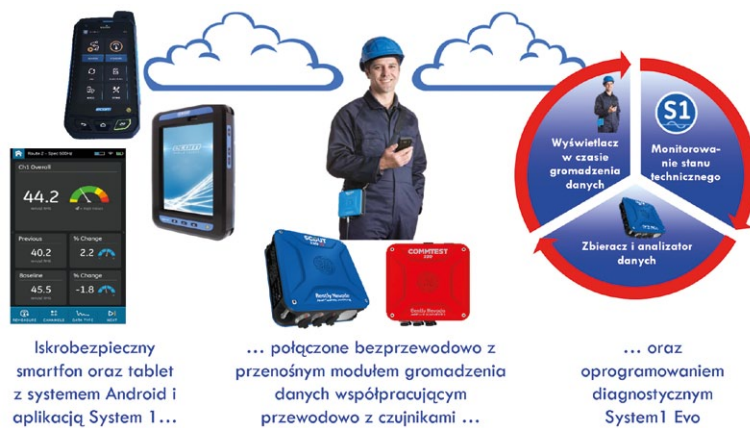
Rys. 18. Dane gromadzone z pomocą sprzętu przenośnego wspomaganego smartfonem z aplikacją diagnostyczną dedykowaną jego obsłudze
