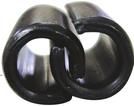
Rys. 4. Przykład zablokowanych kołków rozciętych
