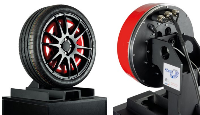
Rys. 1. Wykonany prototyp silnika do zabudowy w kole
