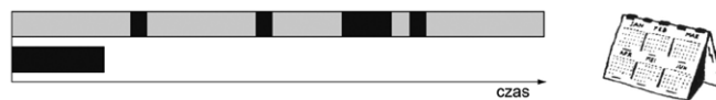
Rys. 3. Eksploatacja planowo-zapobiegawcza. Relacja między czasem eksploatacji (produkcji) – kolor szary – a czasem awarii (postoju) – kolor czarny [1.29]
