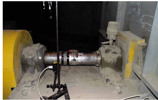
Rys. 23. System telemetryczny do pomiaru momentu na wale maszyny
