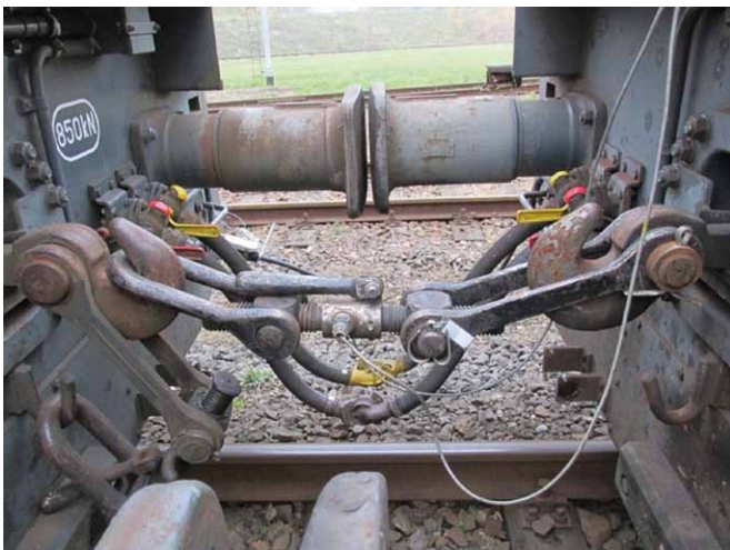
Rys. 2. Tensometryczny sprzęg do pomiaru siły na haku lokomotywy
