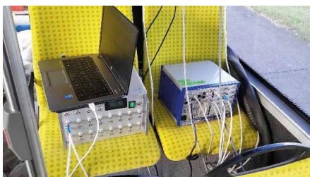
Rys. 4. Cyfrowy rejestrator do pomiaru parametrów elektrycznych
