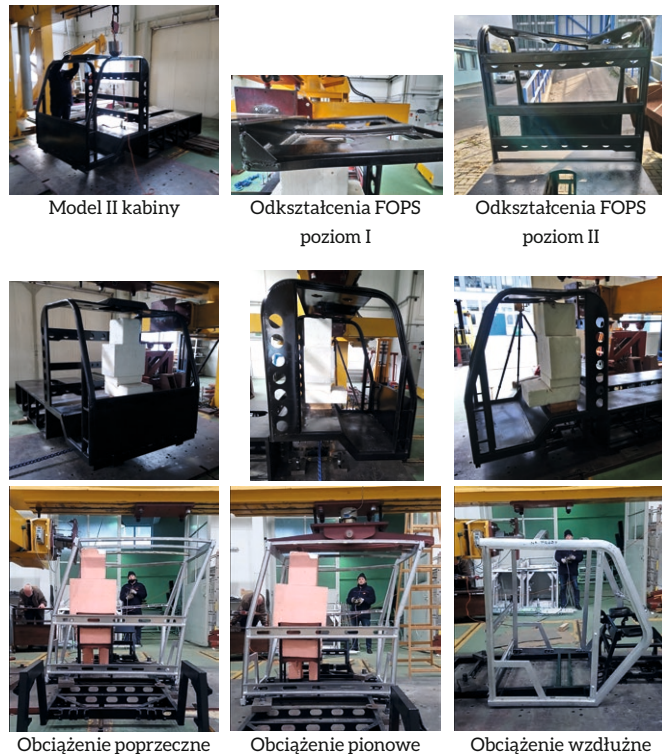
Rys. 8. Przebieg badania FOPS i ROPS kabiny stalowej oraz ROPS kabiny aluminiowej
