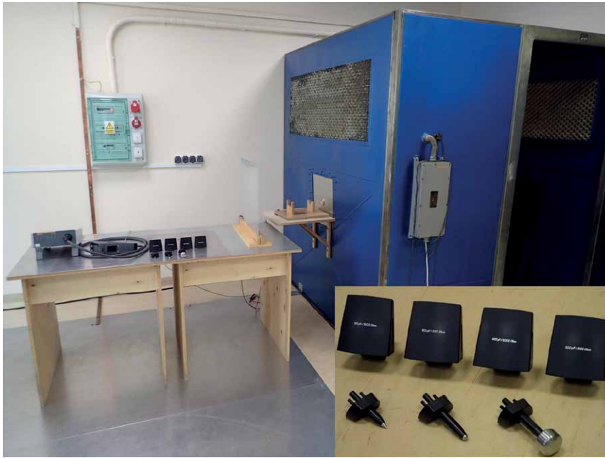
Rys. 6. Stanowisko stołowe do badań odporności na wyładowania ESD w WITU Zielonka
