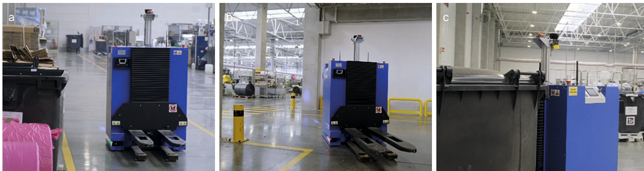
↑ Rys. 7. A – robot manewrujący w zadanych korytarzach roboczych; B – robot AGV pokonujący fragment hali przypominający skrzyżowanie dróg; C – robot AGV z pojemnikiem i w tle widoczny kod QR innego pojemnika transportowego
