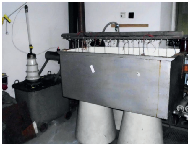
Rys. 3. Wanna wysokonapięciowa i transformator próbnicy TP
