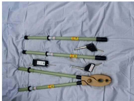
Rys. 6. Kleszcze, drążki izolacyjne i wy- mienne wskaźniki napięcia
