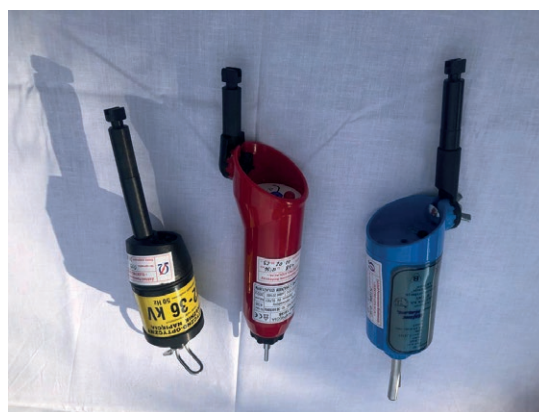
Rys. 7. Wskaźniki pojem- nościowe napięcia
