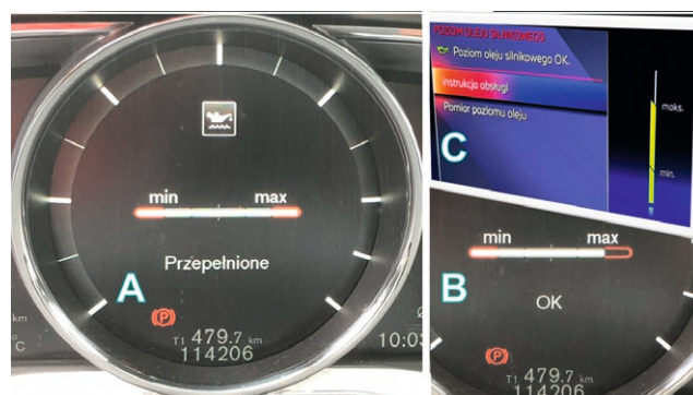
↑ Rys. 3. Wyniki elektronicznej bieżącej indykacji poziomu oleju (A) NOT OK bowiem poziom za wysoki, (B) i (C) OK
