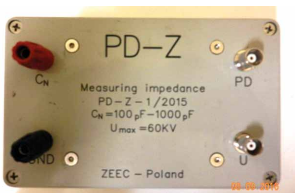
Rys. 15. Moduł wykonanej impedancji pomiarowej [168]
