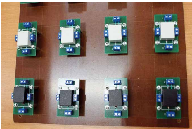
Rys. 10. Zestaw czujników RTD o dwu wyjściach [12]
