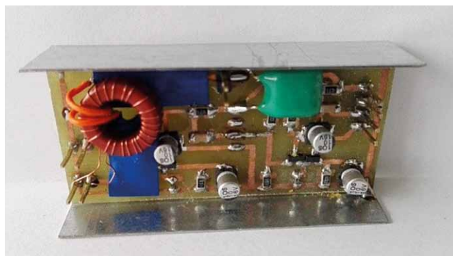
Rys. 8. Prototyp aktywnego czujnika RTD [12]
