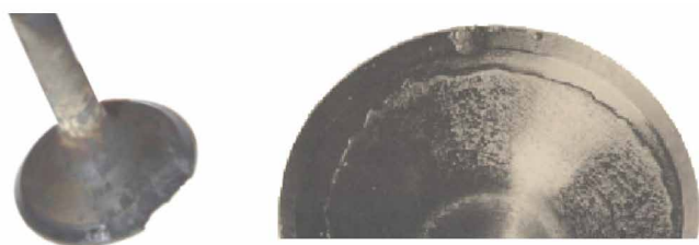
Rys. 8. Przykłady uszkodzenia zaworu wynikającego z obecności nagaru
