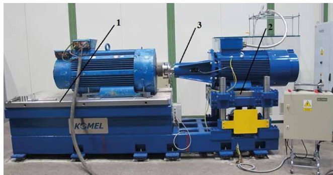
Rys. 1. Stanowisko montażowe hamowni 200 kW
