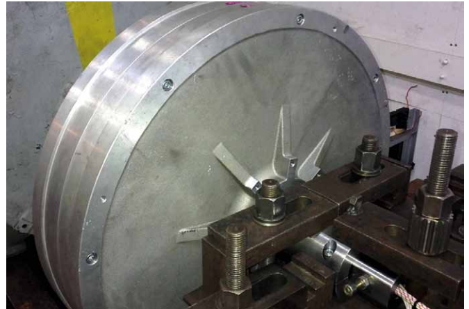
Rys. 12. Generator synchroniczny z magnesami trwałymi
