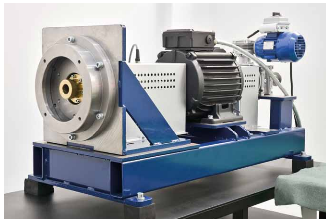
Rys. 3. Stanowisko montażowe hamowni 15 kW
