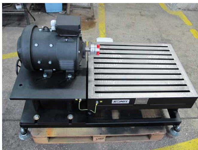
Rys. 2. Stanowisko montażowe hamowni 11 kW
