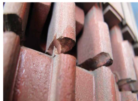
Rys. 4. Przełom uszkodzonych prętów wirnika silnika trakcyjnego
