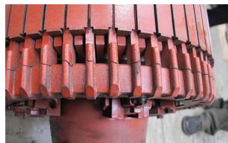
Rys. 3. Uszkodzone uzwojenie wirnika silnika trakcyjnego
