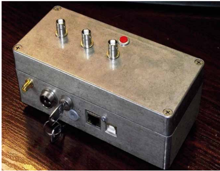
Rys. 1. Autonomiczny system akwizycji danych w wykonaniu trójkanałowym
