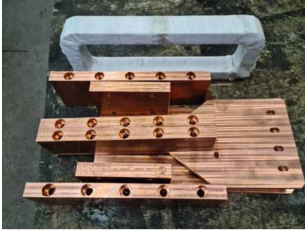
Rys. 10. Rdzeń oraz elementy uzwojenia transformatora typu 1TTFW-95 550//15 V 10 kHz 6 kA S3 WF = 4 l/min
