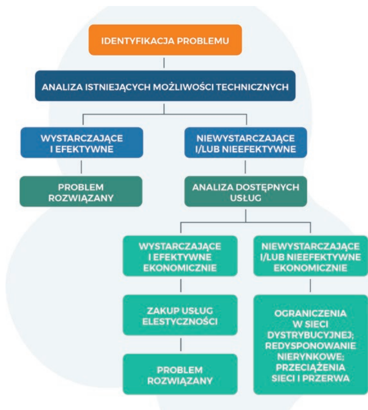
Rys. 3. Uproszczony model procesu zamawiania usług elastyczności według dyrektywy (UE) 2019/944 [5]
