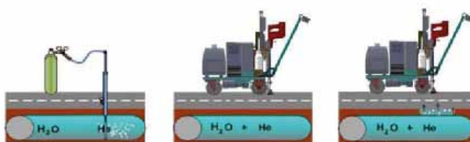
Rys. 10. Technologia iniekcji gazu z wykorzystaniem helu [9]
