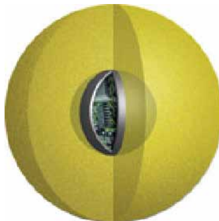
Rys. 8. Samopływający system do lokalizacji wycieków i poduszek powietrznych [10]
