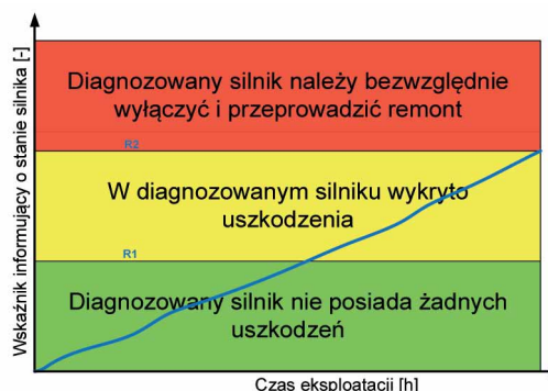
Rys. 4. Ilustracja idei śledzenia stanu maszyny
