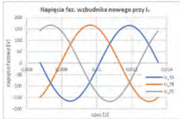
Rys.10. Obliczone w algorytmie [5, 6] przebiegi czasowe napięć fazowych na zaciskach nowego wzbudnika, dla warunków zasilania: I_N, f_N
