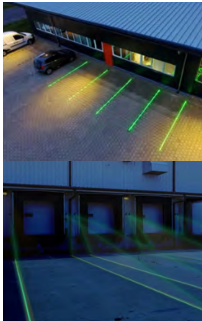
Rys. 2. Linie świetlne miejsc parkingowych, źródło: [9]
