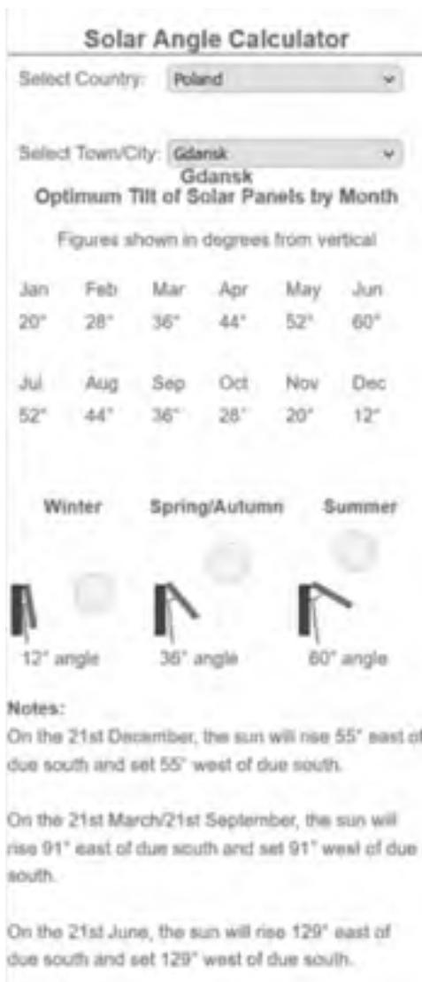
Rys 5.10. Optymalny kąt nachylenia modułów fotowoltaicznych dla poszczególnych miesięcy i pór roku dla miasta Gdańsk, obliczony za pomocą kalkulatora kąta słonecznego [17]
