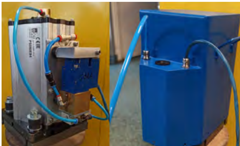
Rys. 3 Wnętrze wzbudnika WZB 2a i jego obudowa
