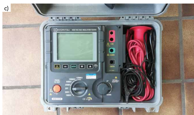
Rys. 1. Wysokonapięciowe mierniki rezystancji izolacji: a) Sonel MIC-10k1; b) Megger S1-1052; c) Kyoritsu KEW 3128
